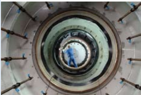
Cooling unit for 1.6 meter PE pipe.
