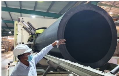
مقدمة من شركة الاتحاد لصناعة الأنابيب، أنبوب بقطر خارجي يبلغ 1200 ميليمتر ونسبة بعد قياسي 11، وسماكة 109 ميليمتر
