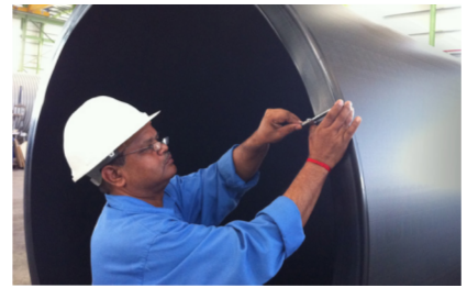
الصورة مقدمة من شركة الاتحاد لصناعة الأنابيب، أنبوب بقطر خارجي يبلغ 2,000 ميليمتر ونسبة بعد قياسي 21، وسماكة 95 ميليمتر
