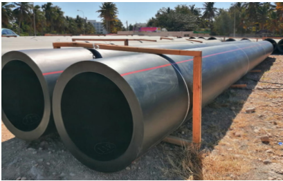
الصورة مقدمة من منى نور، أنبوب بقطر خارجي يبلغ 800 ميليمتر ونسبة بعد قياسي 11، وسماكة 73 ميليمتر
